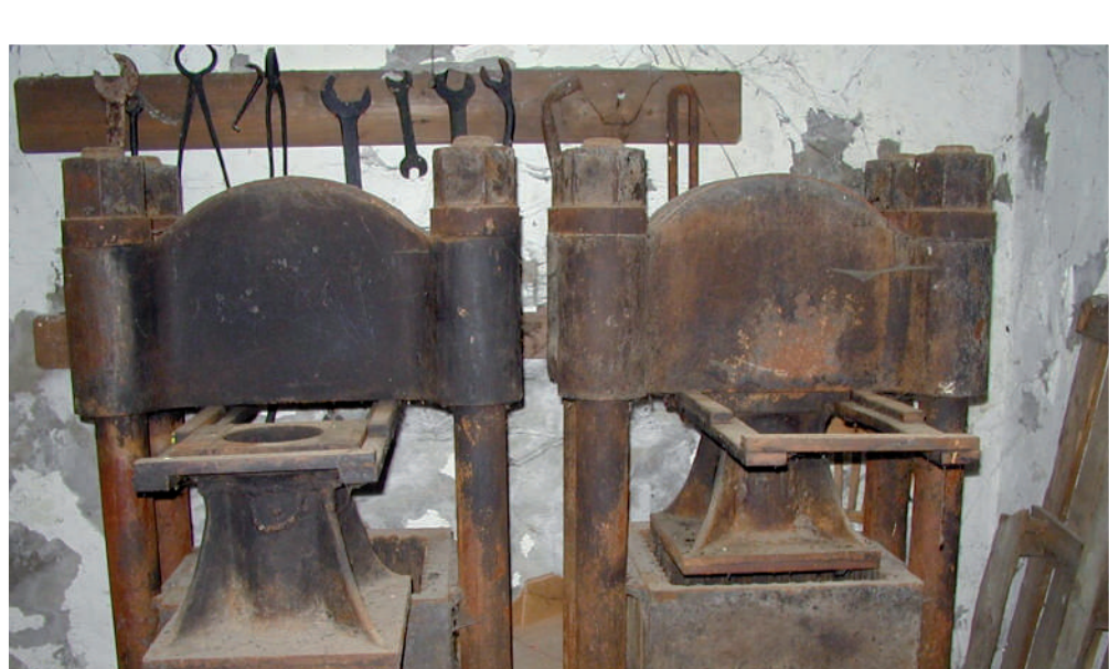
Huilerie, presses hydrauliques : La pâte est pressée pour extraire l'huile.
