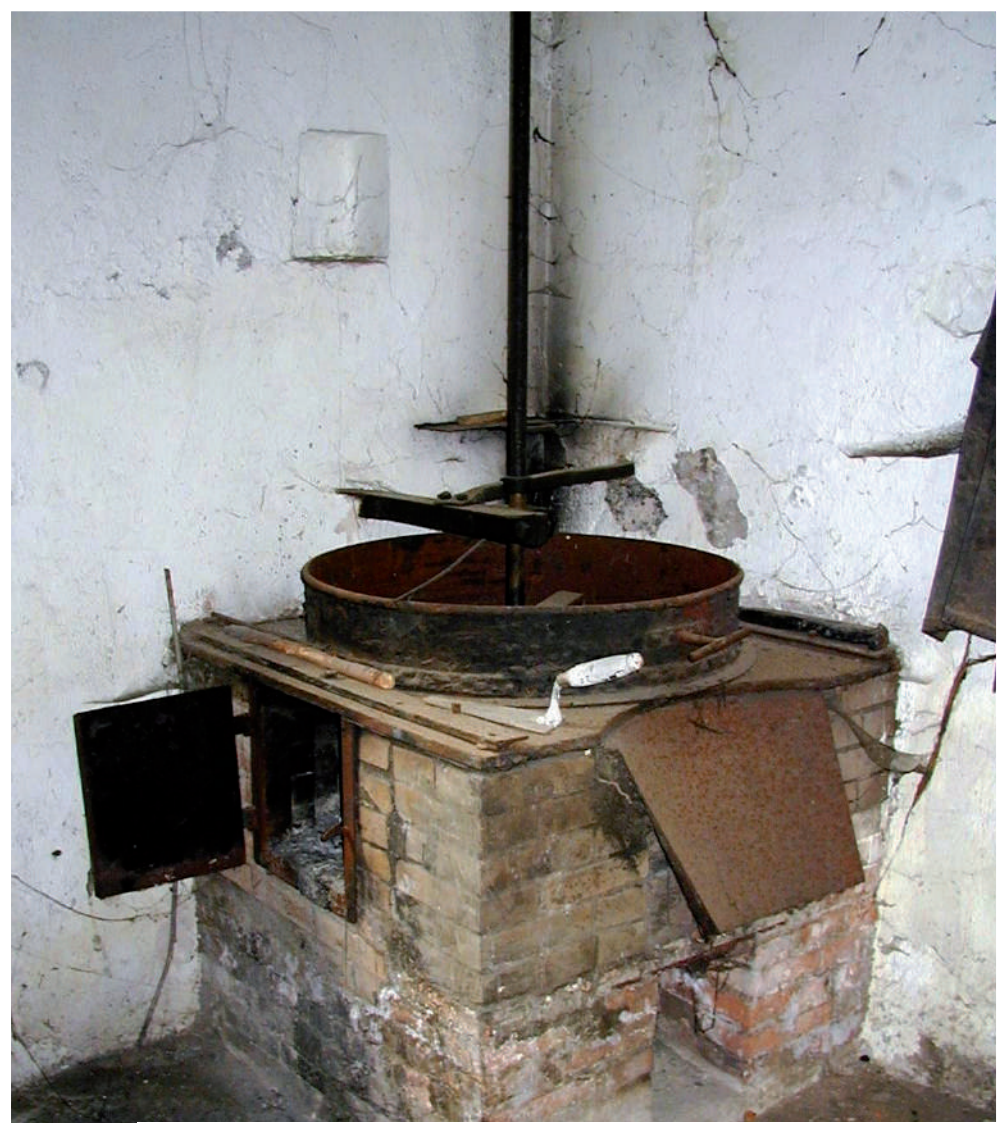
Huilerie, foyer de chauffe : La pâte est chauffée à 50°C environ.
