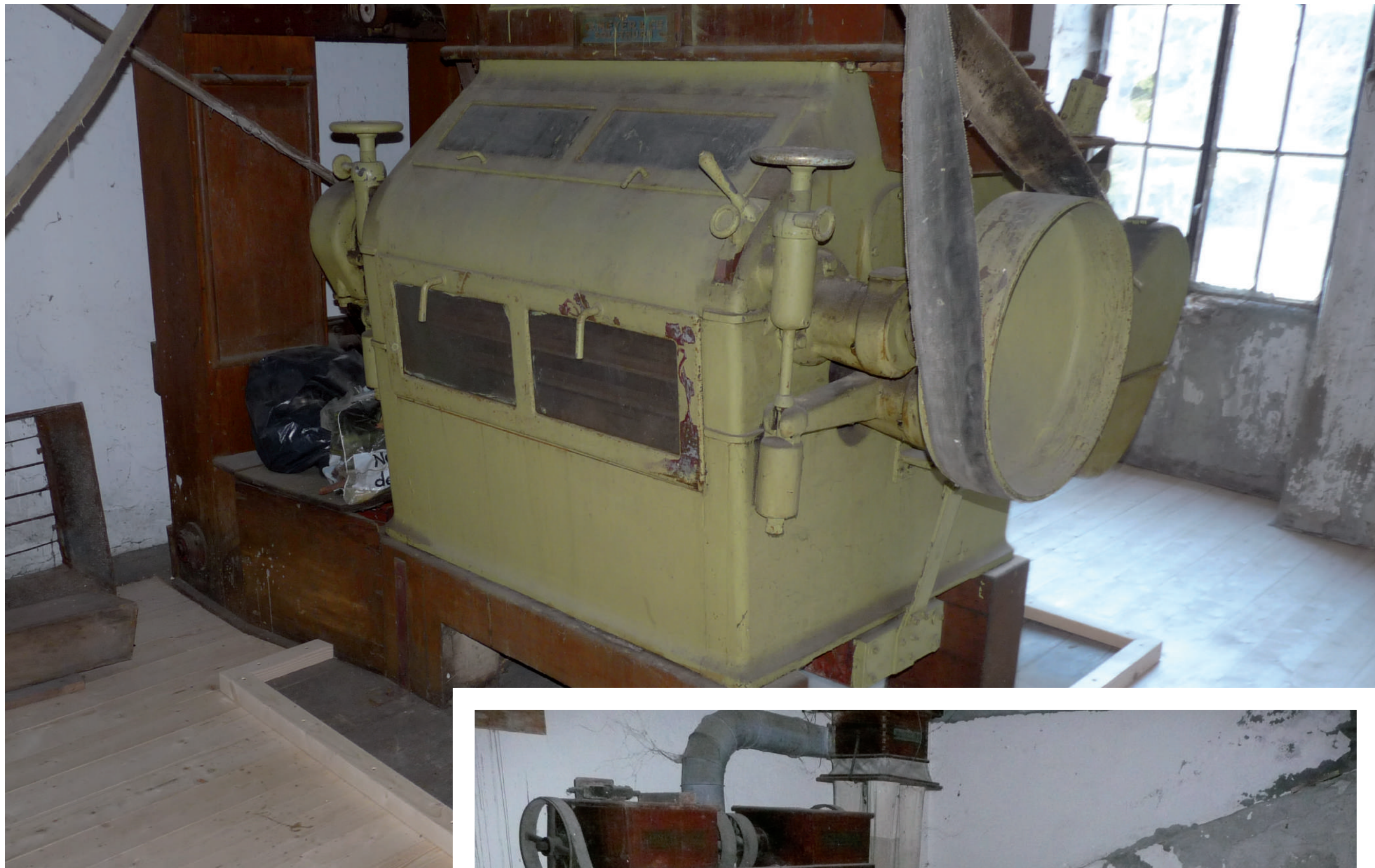
Mouture à l'anglaise : Cylindres fonte et porcelaine qui remplacent les meules en pierre.
